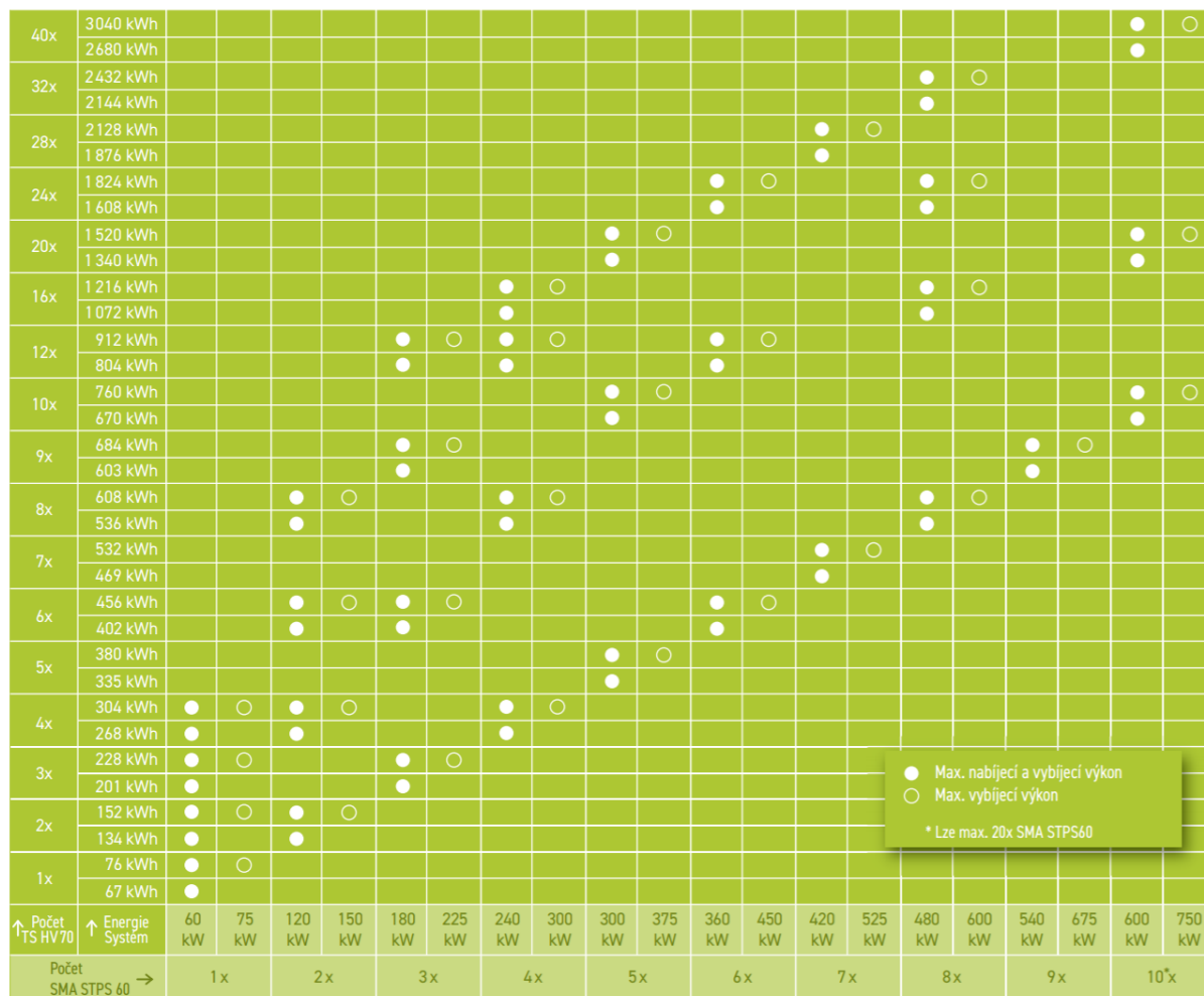
Obr. 4-6 Konfigurace systému - dostupný výkon v závislosti na energii a počtu měničů SMA STPS 60 [33]
